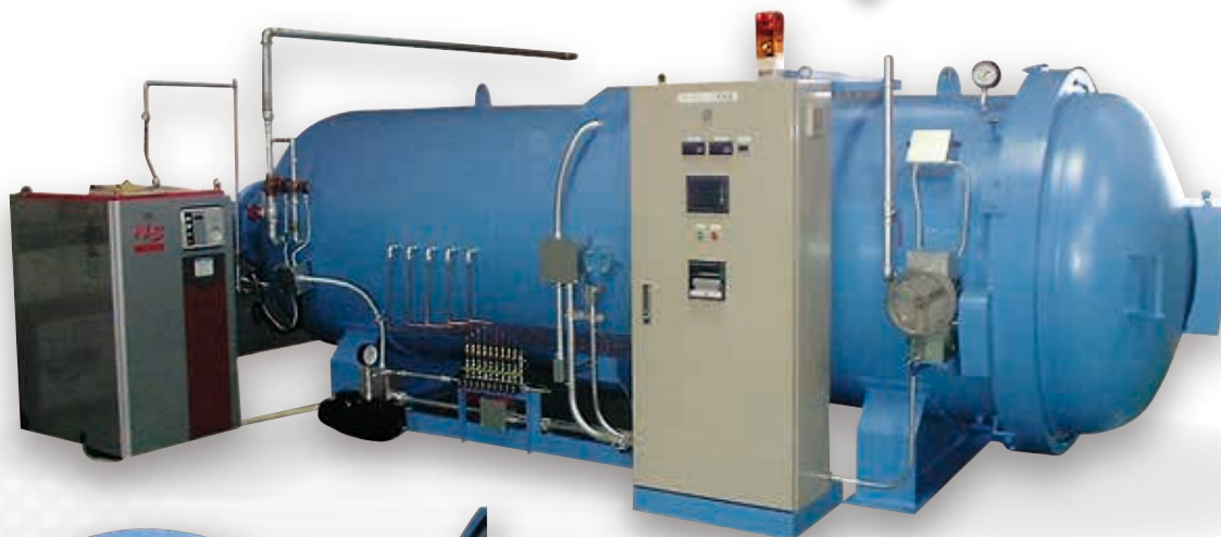
全周熱風循環構造 (大型・複雑製品成形に適する)
